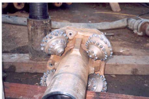
Detalhes Hole Opener após Alargamento
